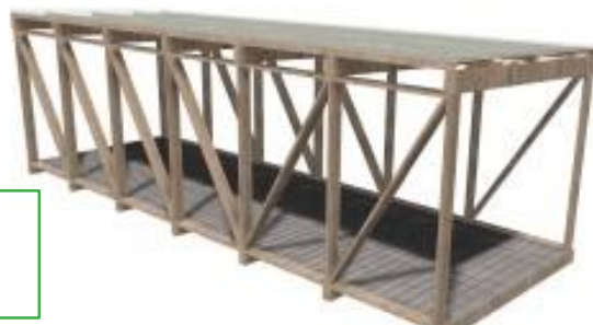
Estructura soportante de madera
