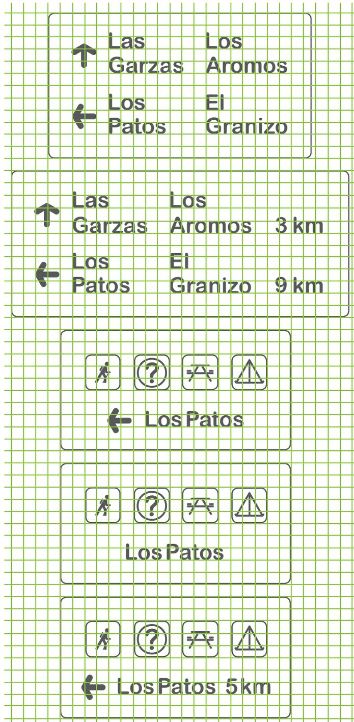
Al coexistir en un signo pictogramas y letras es necesario que la separación del pictograma con el borde superior sea de 2 módulos "o" para mantener la misma separación que tienen las letras con el borde inferior.
